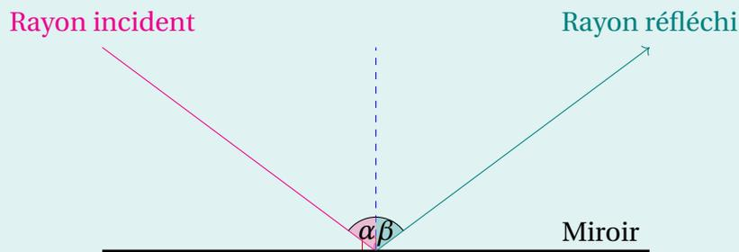
*L'angle d'incidence  $\alpha$  et l'angle de réflexion  $\beta$  sont symétriques par rapport à la droite en pointillés, perpendiculaire au miroir.*
